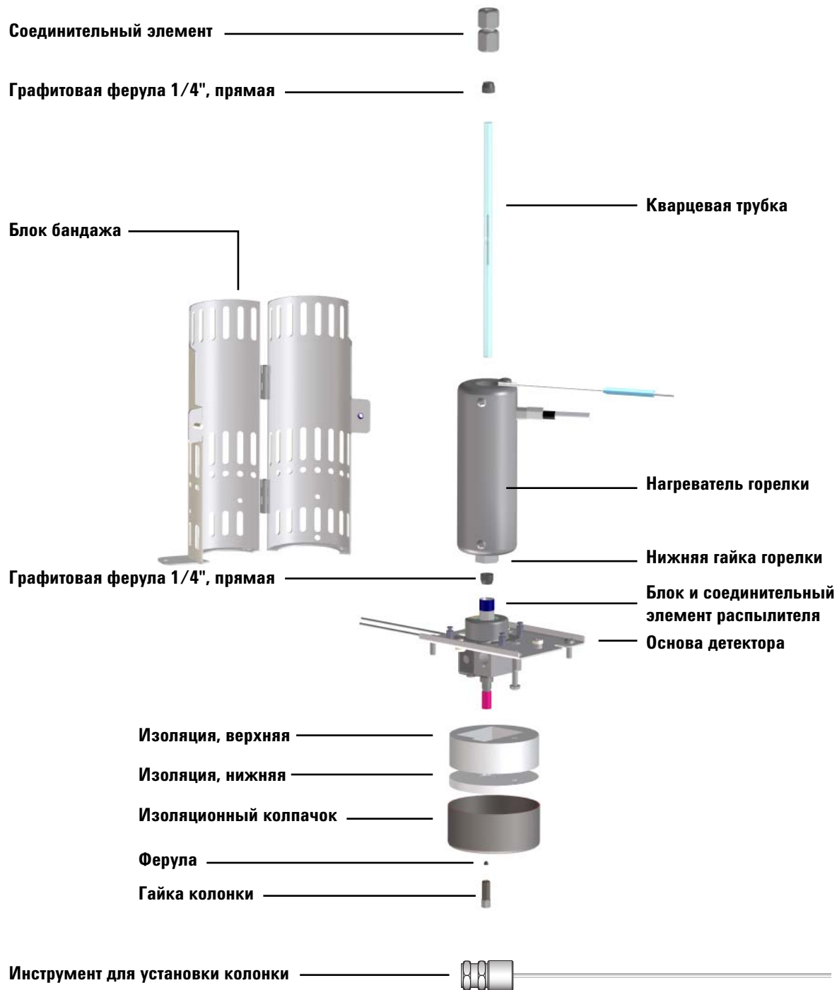
Рис. 13 ХДА в разобранном виде
