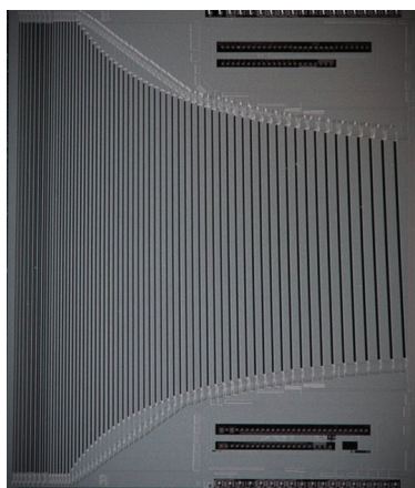
Рис. 2. Запатентованный CCD-детектор специальной конструкции. Благодаря уникальным технологиям I-MAP и АИТ он охватывает весь спектральный диапазон (167–785 нм) и не имеет себе равных по скорости и универсальности.
