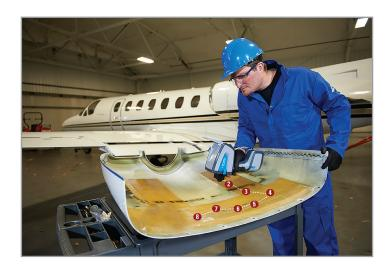
**Измерения в режиме реального времени.** ПО для проведения мобильных измерений MicroLab Mobile от Agilent создавалось и оптимизировалось специально для переносных и портативных спектрометров. Спектральный дисплей, работающий в режиме реального времени, дополняет возможность быстрого сканирования спектрометра 4300 с ТКР-детектором.
