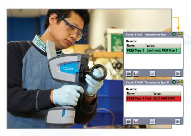
В выбранном для анализа уплотнительных колец методе MicroLab порог был установлен таким образом, что образцы в пределах целевой группы были помечены зеленым цветом, а за ее пределами — красным. Кроме того, для отображения настраиваемых предупреждающих сообщений (например, «Confirmed FKM Type 1» (Подтвержден тип FKM 1) для образцов в пределах целевой группы и «NOT FKM TYPE 1» (Не соответствует типу FKM 1) для образцов за ее пределами) может использоваться функция условной отчетности.
