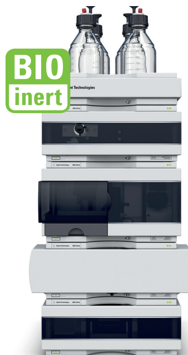
Система ВЭЖХ Agilent 1260 Infinity Bio-inert с четырехканальным насосом
