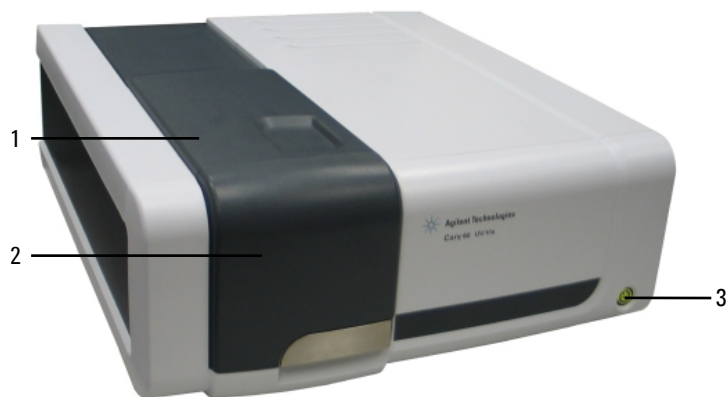
Рис. 5. Показаны крышка отделения пробы (1), передняя дверца отделения пробы (2) и кнопка включения (3).
