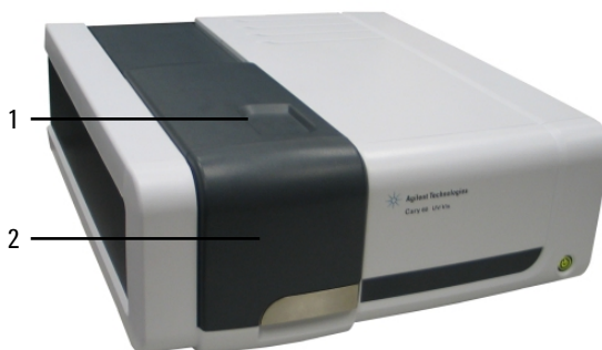
Рис 4. На рисунке показана крышка отделения пробы (1) и передняя дверца (2)
