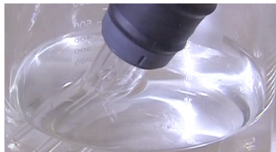
Рис. 14. Приближенное изображение помещенной в контейнер горелки с указанием уровня кислоты относительно пластикового основания
