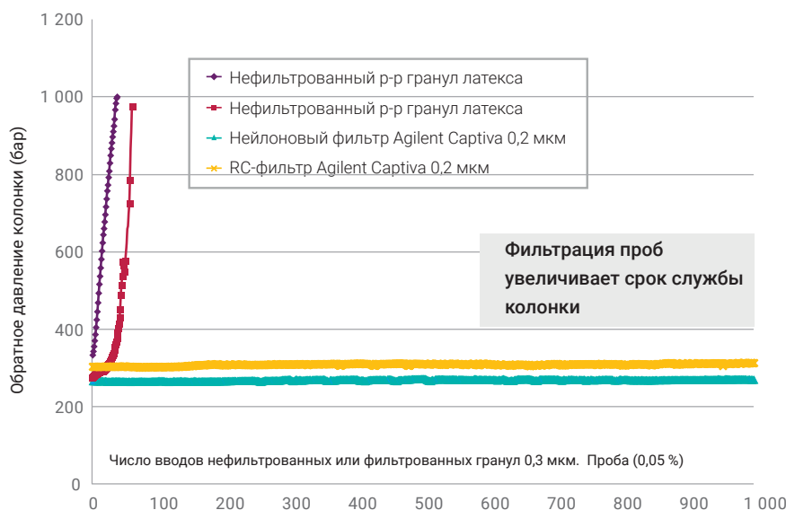
Влияние фильтрации смеси латексных гранул размером 0,3 мкм на срок службы колонки с частицами размером до 2 мкм
