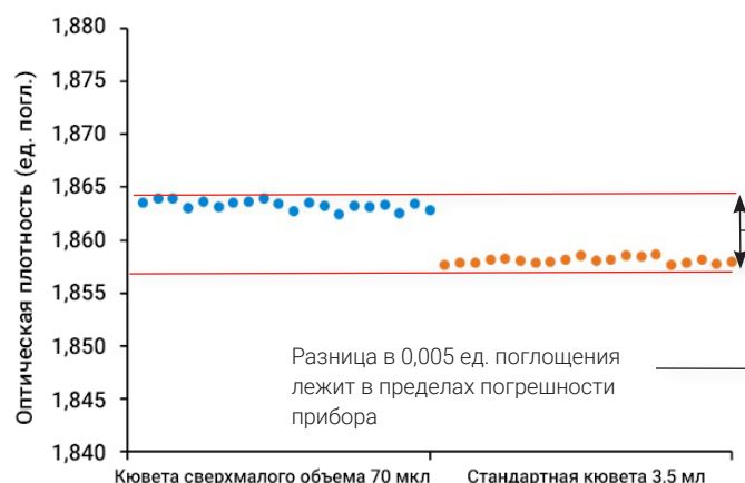
Рис. 4. Оптическая плотность 20 повторных измерений в кювете сверхмалого объема 70 мкл в сравнении со стандартной кюветой объемом 3,5 мл.
