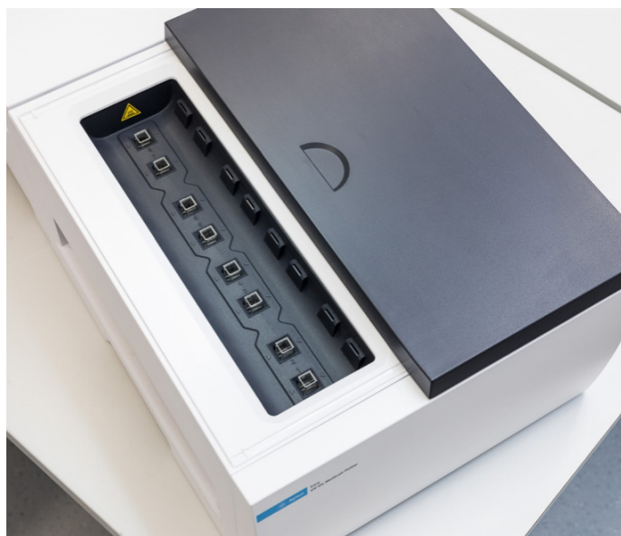
Рис. 1. Отсек для образцов УФ-Вид спектрофотометра Cary 3500 Multizone со встроенным многокюветным держателем. Держатель позволяет поддерживать для каждой пары измеряемого раствора и раствора сравнения различные температуры.
