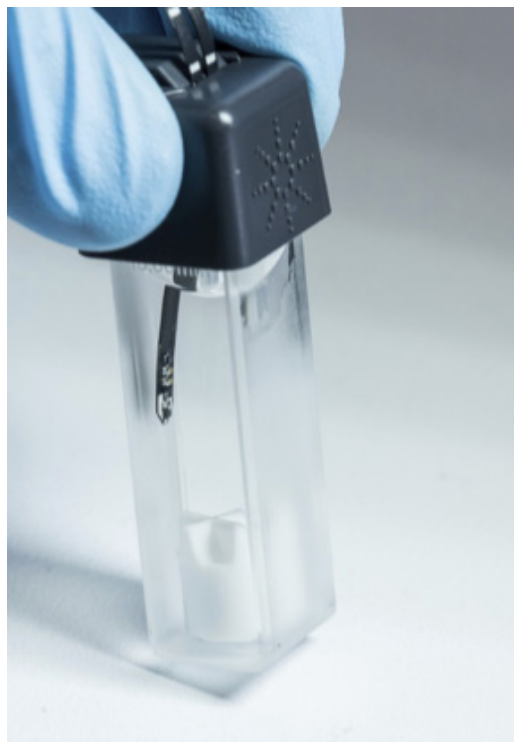
Рис. 2. Погружной температурный зонд, с помощью которого контролировалась температура в ходе эксперимента.
