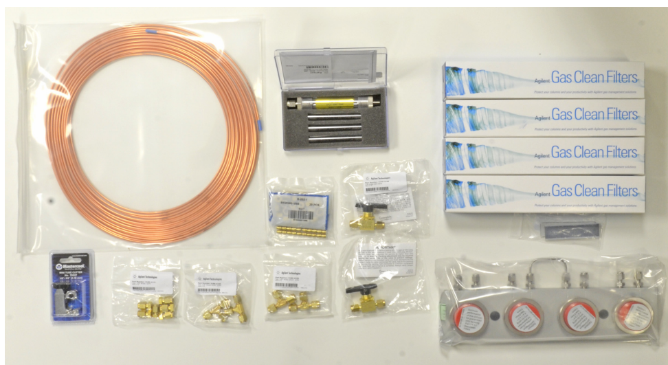
Рис. 1. Комплект для установки линии подачи газа в ГХ с очистителями газа 19199N
