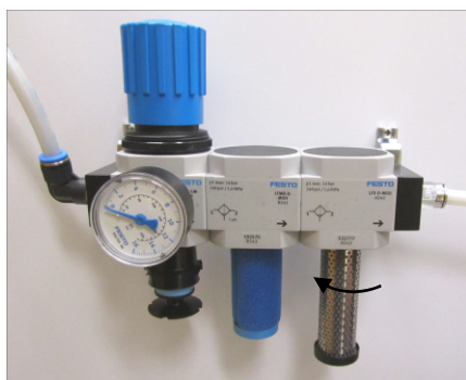
Рис. 8. Газовые фильтры генератора азота без корпусов
