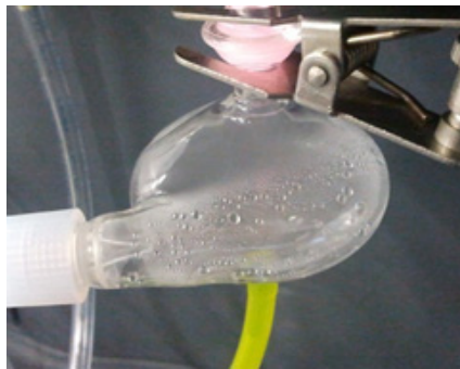
Рис. 7. Распылительная камера с неправильным увлажнением, в которой видны капли
