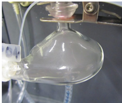
Рис. 6. Распылительная камера с правильным увлажнением с однородным покрытием
