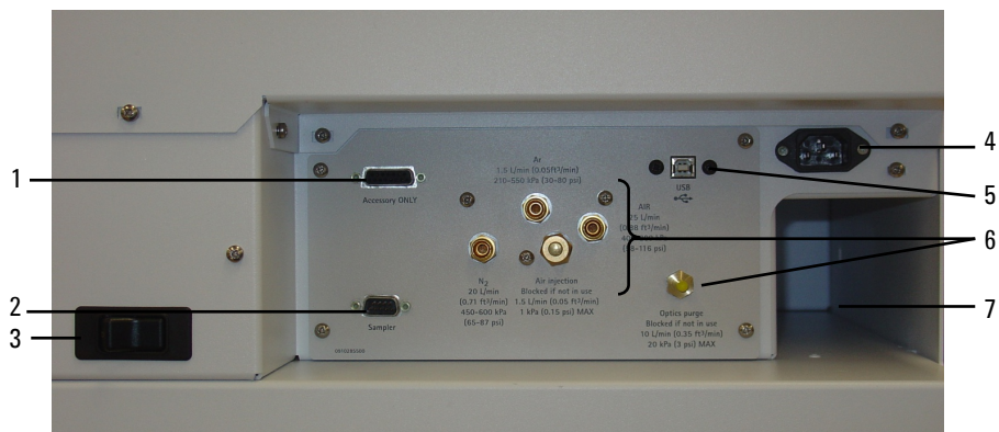
Рис. 2. Входные и выходные подключения на боковой панели прибора МП-АЭС
